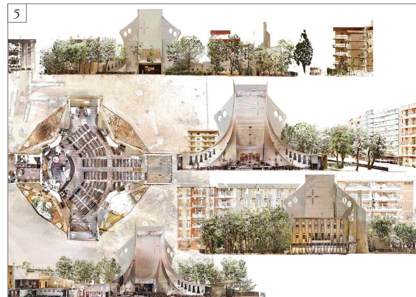
Figura 5 Immagini del rilievo: elaborazioni della nuvola di punti laser, 2025.
